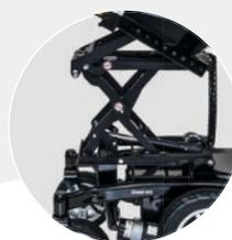
Inclinaison de l'assise électrique avec élévateur à ciseaux en option 300 mm
