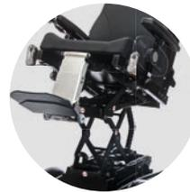
Inclinaison électrique de l'assise et élévateur à ciseaux pour une décompression efficace et un positionnement optimal
