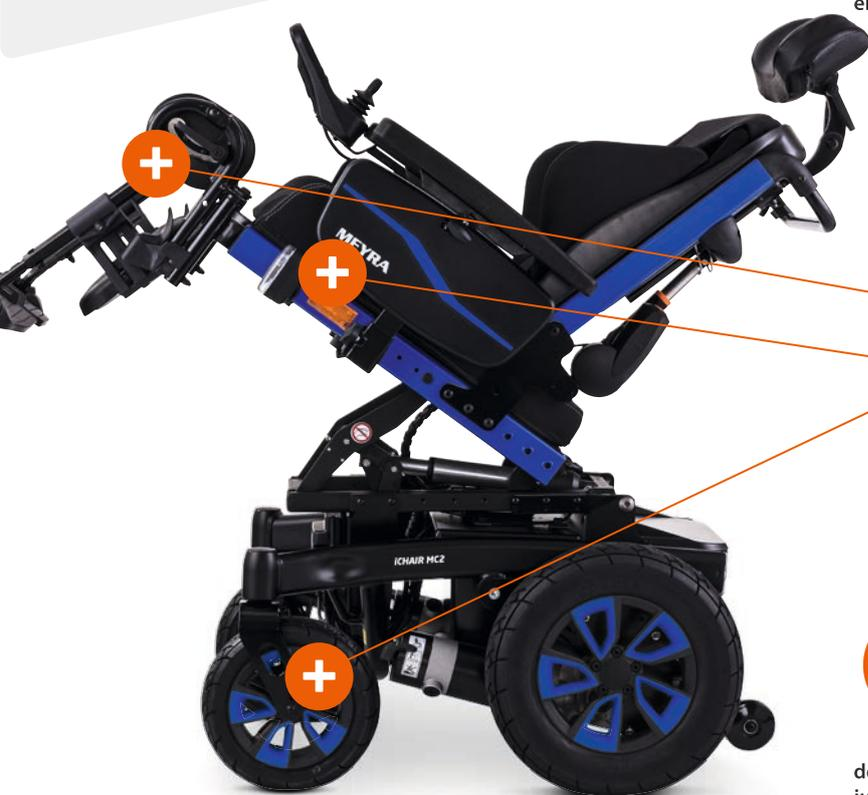
Repose-jambes à réglage électrique (en option)
