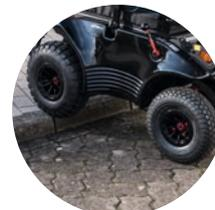
Hauteur d'obstacle jusqu'à 110 mm
